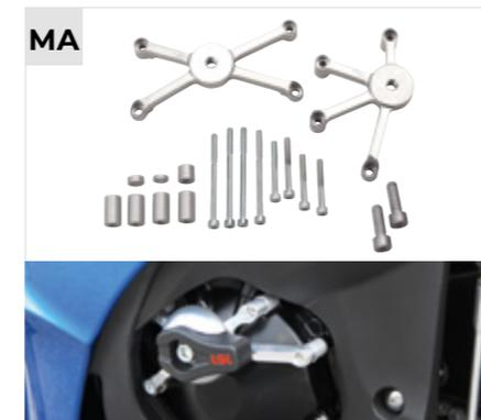
Adapterplatte verschraubt über den Motordeckeln.
