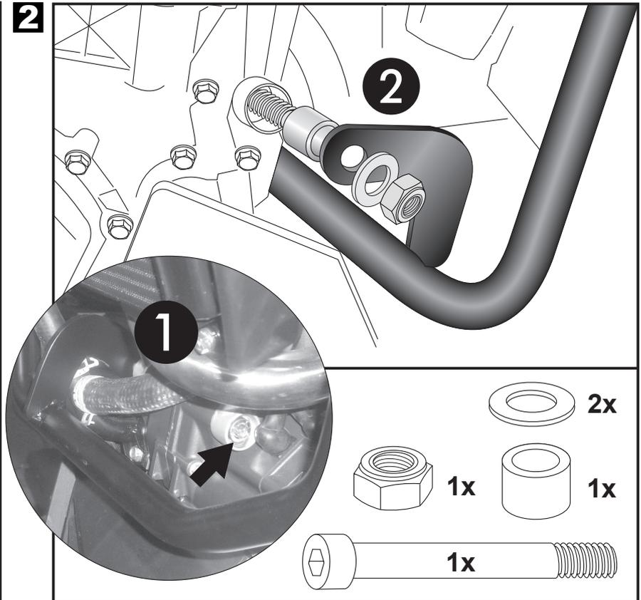
Nach der Montage alle Verschraubungen auf festen Sitz kontrollieren ! Abgebaute Teile wieder montieren.
