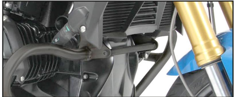
**Nach der Montage alle Verschraubungen auf festen Sitz kontrollieren ! Abgebaute Teile wieder montieren.**
