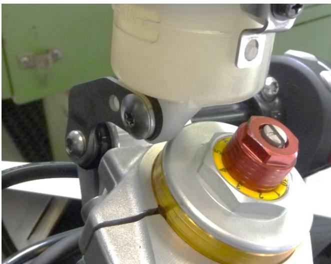
Befestigen Sie den mitgelieferten Halter am Bremsflüssigkeitsbehälter mit der originalen Schraube.
