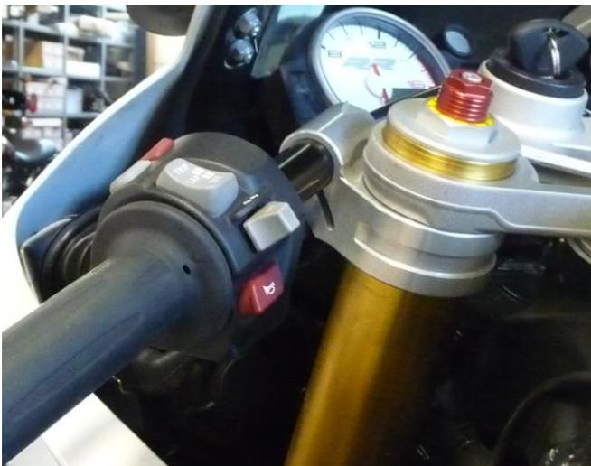
Speed Match Schellen mit 6x25mm bis unter die Gabelbrücke schieben.
