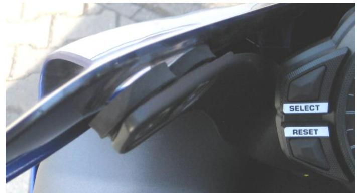
**Bremsflüssigkeitsreservoir:** Den neuen Halter des Bremsflüssigkeitsreservoirs wie abgebildet mit der Schraube M5 x 16 und Sperrkantscheibe am originalen Halter befestigen, dann das Reservoir mit der originalen Schraube und beiliegender U-Scheibe und selbstsichernder Mutter M5 am Halter montieren.
