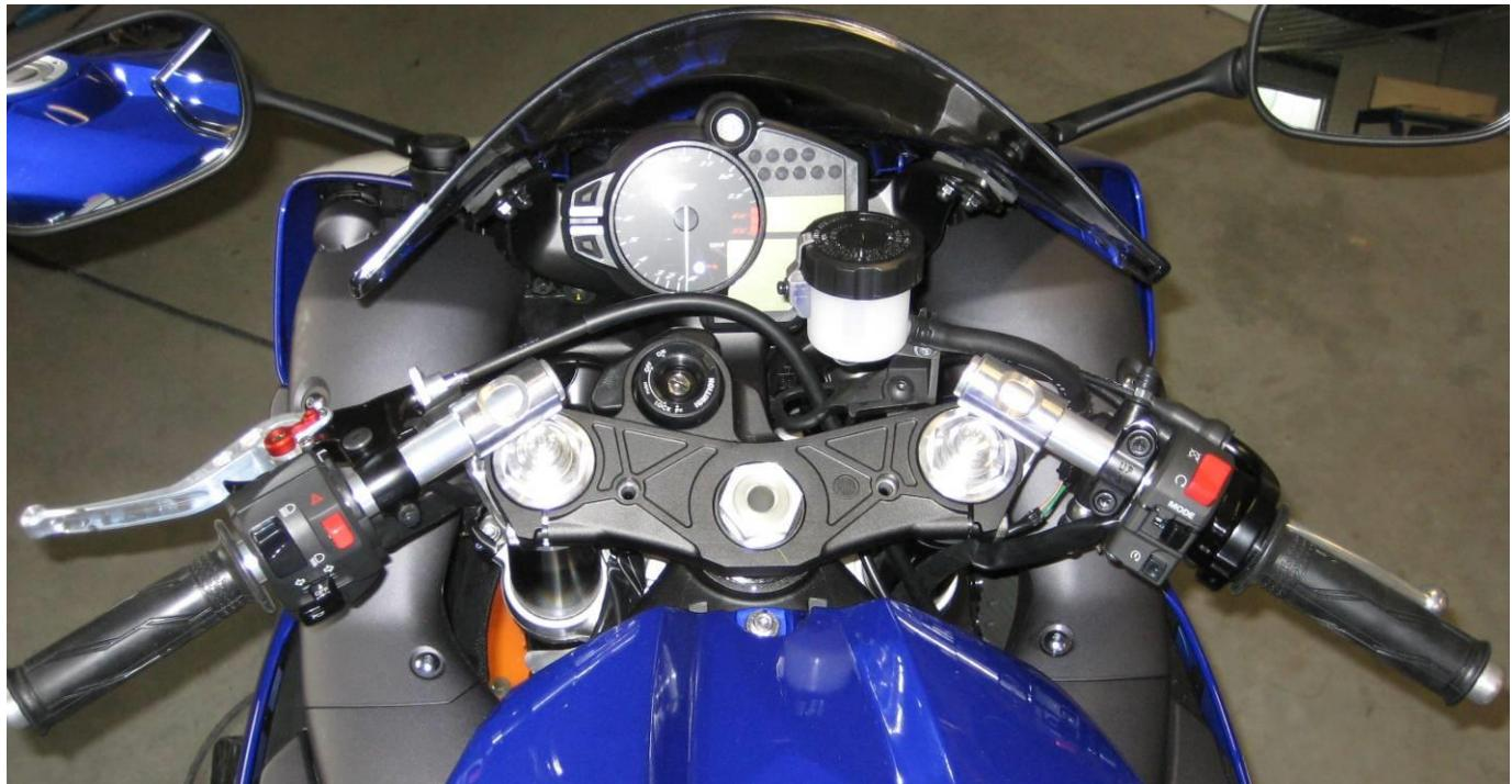
**(i)** Coupez le circuit électrique en débranchant le pôle négatif de la batterie. Démontez la conduite du maître cylindre de frein hydraulique.
