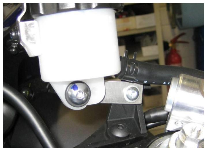
Kontrollieren sie den Freigang zur Verkleidung und zum Tank hin, dazu alle Griffarmaturen zunächst provisorisch auf dem Lenkrohr fixieren. Den Tour-Match durch verdrehen der Klemmschellen auf dem Standrohr ausrichten und abschließend die Klemmschrauben M6x25 mit 10Nm festziehen. Nun die Griffarmaturen auf dem Lenker befestigen, ausrichten und die zur Fixierung nötigen Bohrungen setzen. Das linke Griffgummi mit einem geeigneten Klebstoff verkleben.
