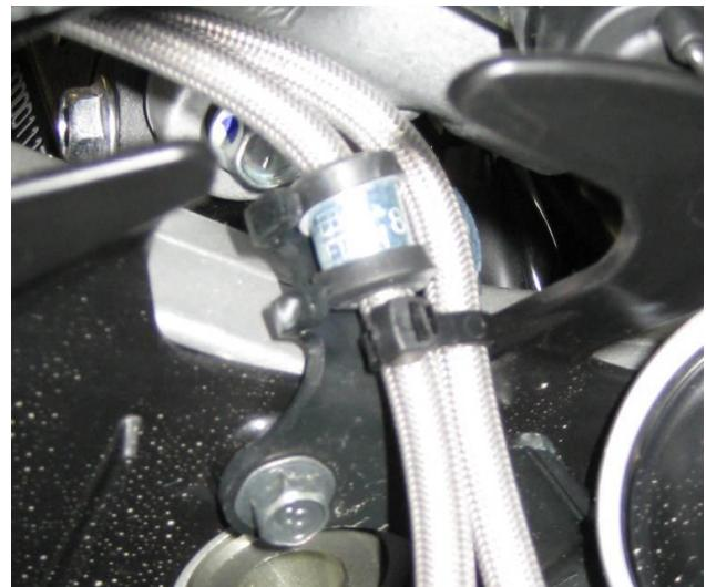
**Kupplungszug (3):** Die Verlegung entspricht dem Original.
