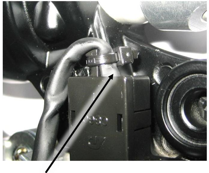
Neue LSL Situation mit Tour Match Lenker – Kabelbinder mit Verschluss neu befestigt
