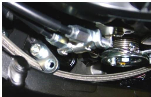
**Armaturenkabel (5&6):** Armaturenkabel von der linken und rechten Armatur aus den Führungen am Rahmen entnehmen und spannungsfrei, hinter den Standrohren zu den Armaturen führen
