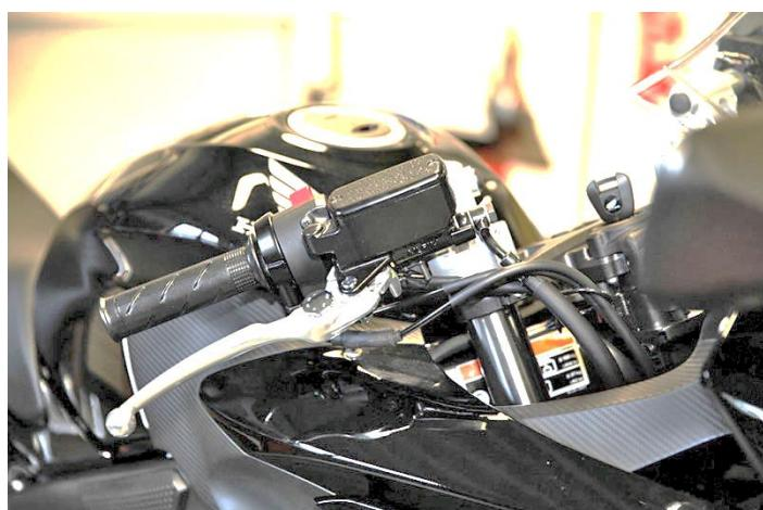
Tournez les câbles des gaz vers le bas pour le montage de la poignée d'accélération et effectuez la pose en-dessous du maître cylindre de frein!
