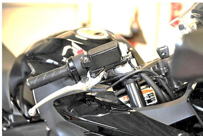
Die Gaszüge zur Montage des Gasgriffs nach unten drehen und die Verlegung unterhalb des Hauptbremszylinders durchführen!
