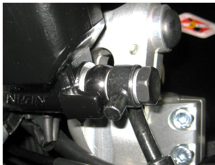
Bremsflüssigkeit mit geeigneten Mitteln auffangen.
