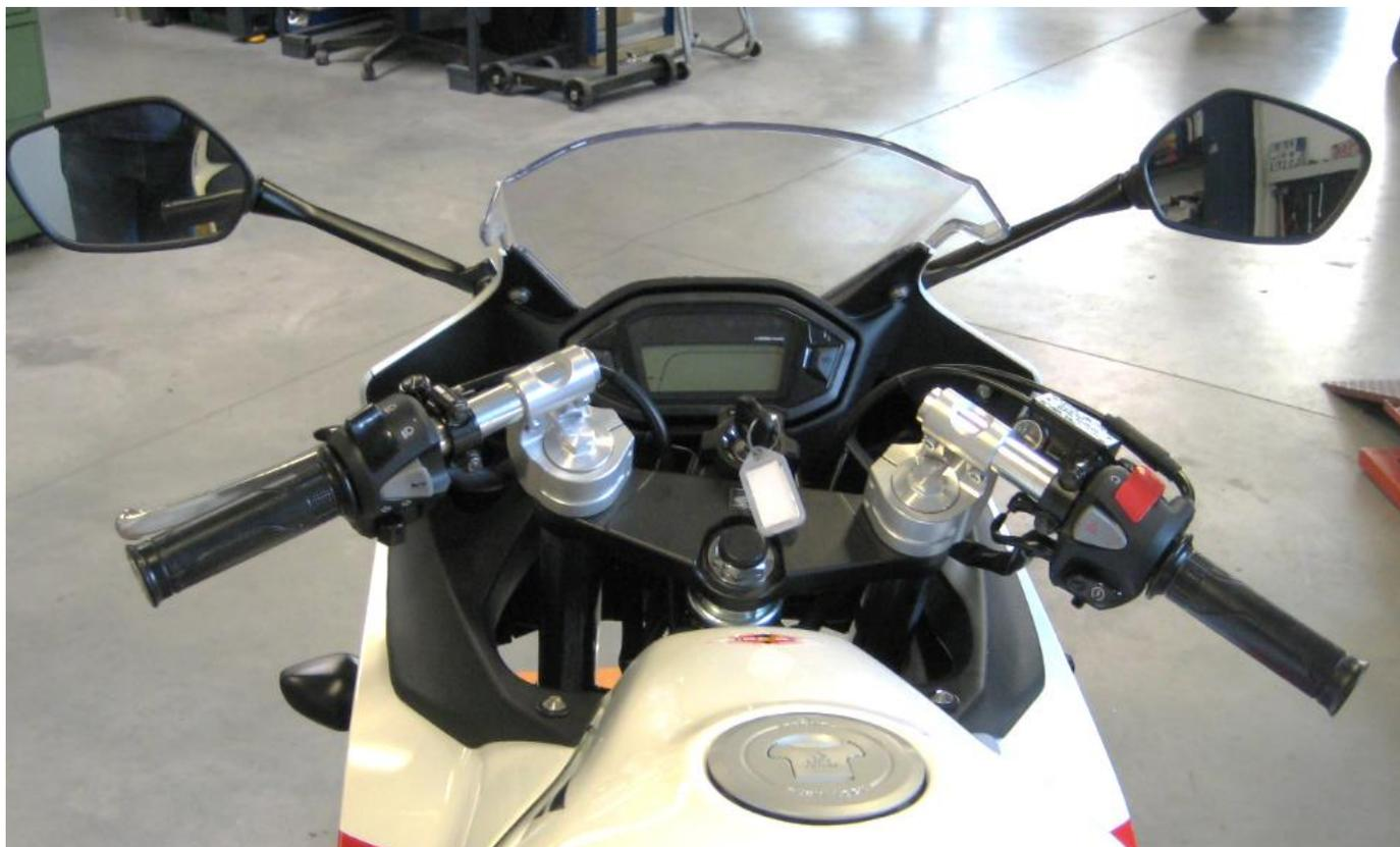
**i** Coupez le circuit électrique en débranchant le pôle négatif de la batterie pendant le montage. Démontez les leviers, les commutateurs et le maître cylindre de frein (et d'embrayage). Supprimez le guidon d'origine.
