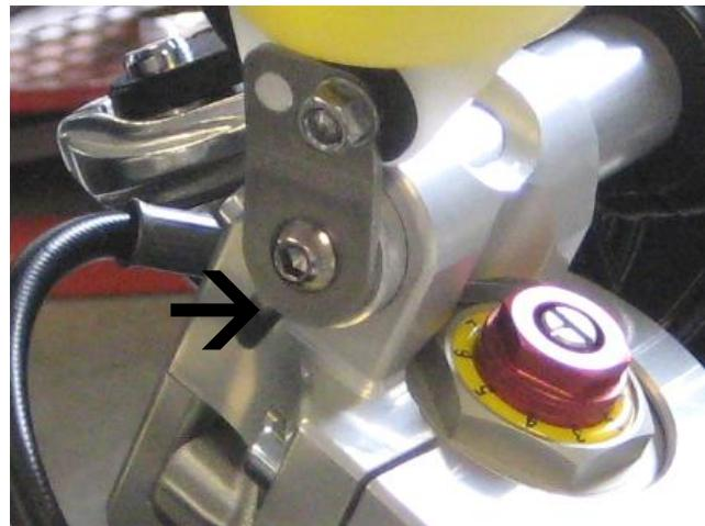
Ajustez le Tour-Match en tournant les colliers de serrage sur le bras de fourche et serrez les vis.
