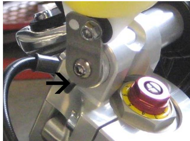
Den Tour-Match durch verdrehen der Klemmschellen auf dem Standrohr nachjustieren und abschließend die Klemmschrauben festziehen.
