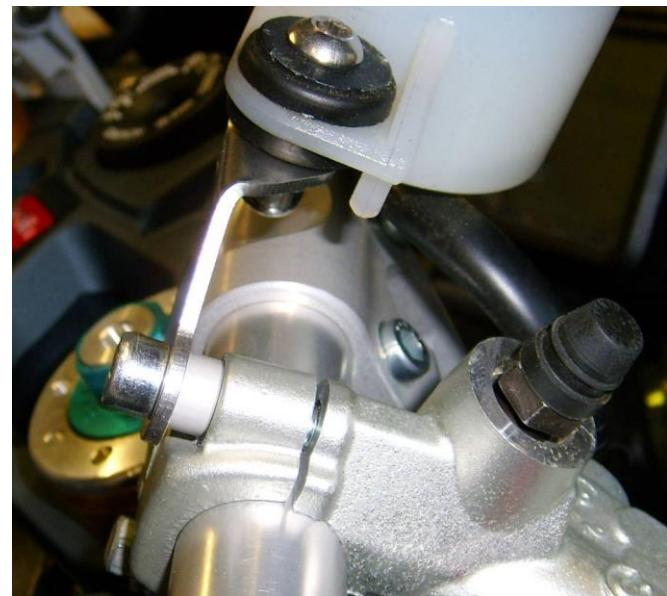
**Kupplungsschlauch (3):** Die Verlegung des Kupplungsschlauches entspricht dem Original. Montieren Sie den Ausgleichsbehälter wie abgebildet mit dem Montagekit für den linken Behälter, Art.-Nr.: 156A015.1
