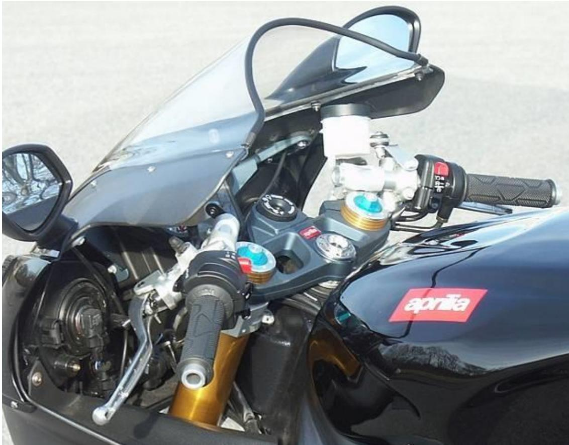
**i** Um später Züge und Leitungen neu verlegen zu können, muss der Tank hochgeklappt werden. Zur Sicherheit der elektrischen Systeme sollte während der Montage die Batterie am Minuspol abgeklemmt werden.
