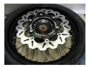
Demontieren Sie am Vorderrad die original Bremsscheibe. Wenn Sie die von LSL vorgesehene Bremsscheibe (Art.Nr: 239T038), Galfer320mm, verwenden, verschrauben Sie die Bremsscheibe unter Verwendung Bremsscheiben-Distanzringes (06), wieder auf der Nabe nur mit den beiliegenden Bundschrauben M8x23mm (07).
