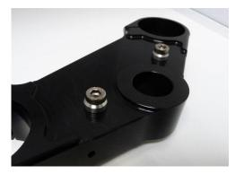
Montieren Sie die Lenkanschläge, bestehend aus Schrauben(03) und Buchsen(04) auf der unteren Gabelbrücke (02).
