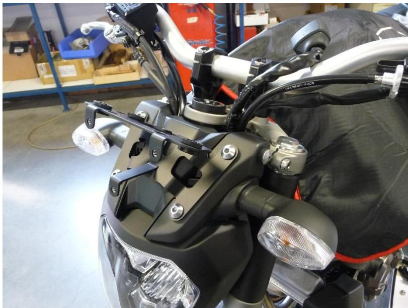
**02.** Montez le guidon spécial LSL avec les commandes et les leviers en observant les mesures décrites du certificat.
