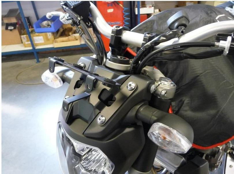
**02.** Montieren Sie den LSL-Sonderlenker mit allen Armaturen unter Beachtung der im Teilegutachten aufgeführten Maßnahmen.
