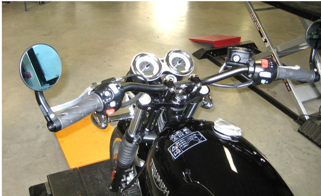
**i** Um Beschädigungen zu vermeiden sollte der Tank und andere, im Montagebereich liegenden Teile des Motorrades abgedeckt werden.
