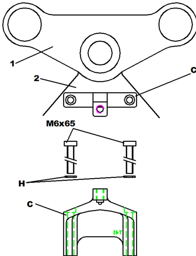
2. Supprimez les vis des points de fixation avant du réservoir d'essence. Posez le support cadre (C) sur la patte de fixation du réservoir d'essence et vissez-le au cadre (2), comme indiqué ci-contre, avec les vis M6x65 et les rondelles dentelées (H).
