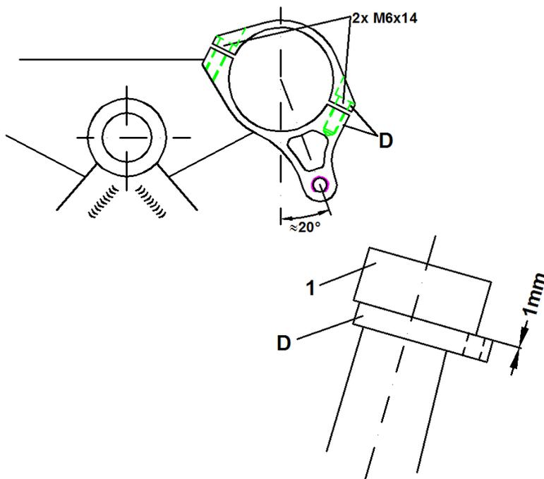
3. Montez le collier de tube de fourche (D) en-dessous du té de fourche supérieur (1) avec les vis M6x14. Positionnez le collier (D) comme indiqué ci-contre. Ne pas encore serrer définitivement, car la position devra éventuellement être modifiée pendant l'ajustage de l'amortisseur de direction.
