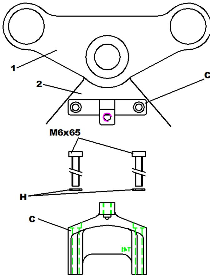
2. Entfernen Sie die Schrauben der vorderen Tankbefestigung. Setzen Sie nun den Rahmenhalter (C) auf die Haltelasche des Tanks und befestigen ihn mit den Schrauben M6 x 65 so wie den Sperrkantscheiben (H), wie abgebildet, am Rahmen (2)
