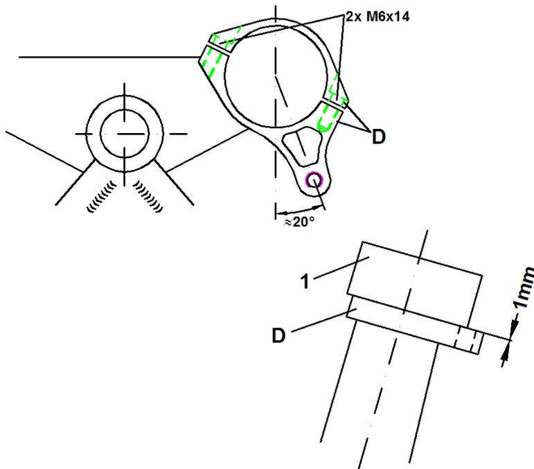
3. Montieren sie nun die Standrohrschele (D) mit den Schrauben M6x14 unterhalb der oberen Gabelbrücke (1). Positionieren sie die Standrohrschele (D) wie in der Zeichnung abgebildet. Schelle jetzt noch nicht endfest montieren, sie muss zur Justierung des Dämpfers eventuell neu ausgerichtet werden
